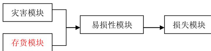
图 1 巨灾风险评估的随机模拟模型的组成
